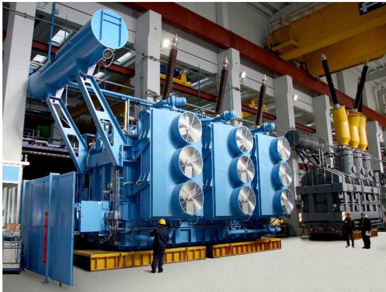
Getra Power: Trasformatori di grande potenza in assetto di collaudo
